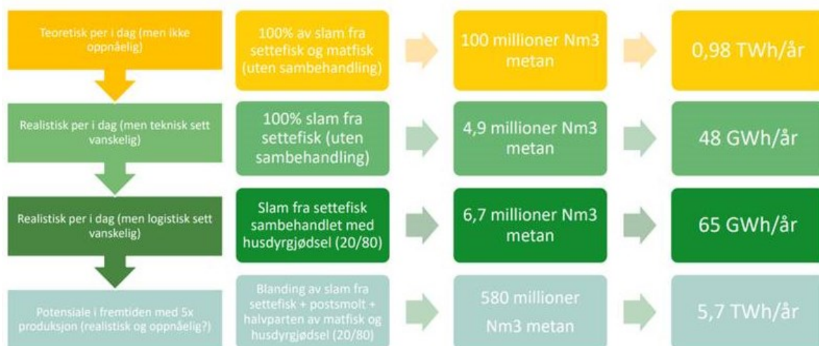
Figur 2: Teoretisk gassutbytte fra fiskeslam fra ulike scenarier. 60,5 Nm3/tonn fiskeslam (15% TS) og 16,5 Nm3/tonn blanding av 20% fiskeslam og 80% husdyrgjødsel. Spesifikk energiinnhold til metan: 9,8 kWh/Nm3 metan (Kilde: Joshua Cabell) 15
