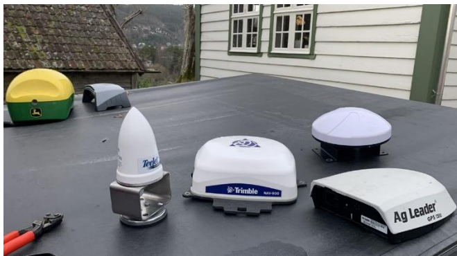
2 Alle mottakarane vi har brukt er dei same som bøndene kjøper til traktorane. Difor er våre resultat jamførbare med kva bonden vil oppleve med sitt eige utstyr.
