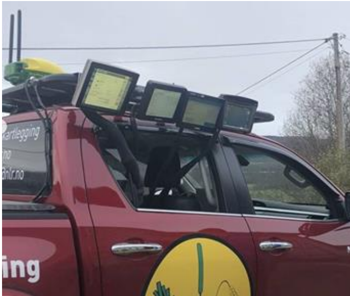
5 Terminalene kan enkelt flyttes ut og monteres langs takgrinda på bilen, for visning, undervisning og demonstrasjonsformål.
