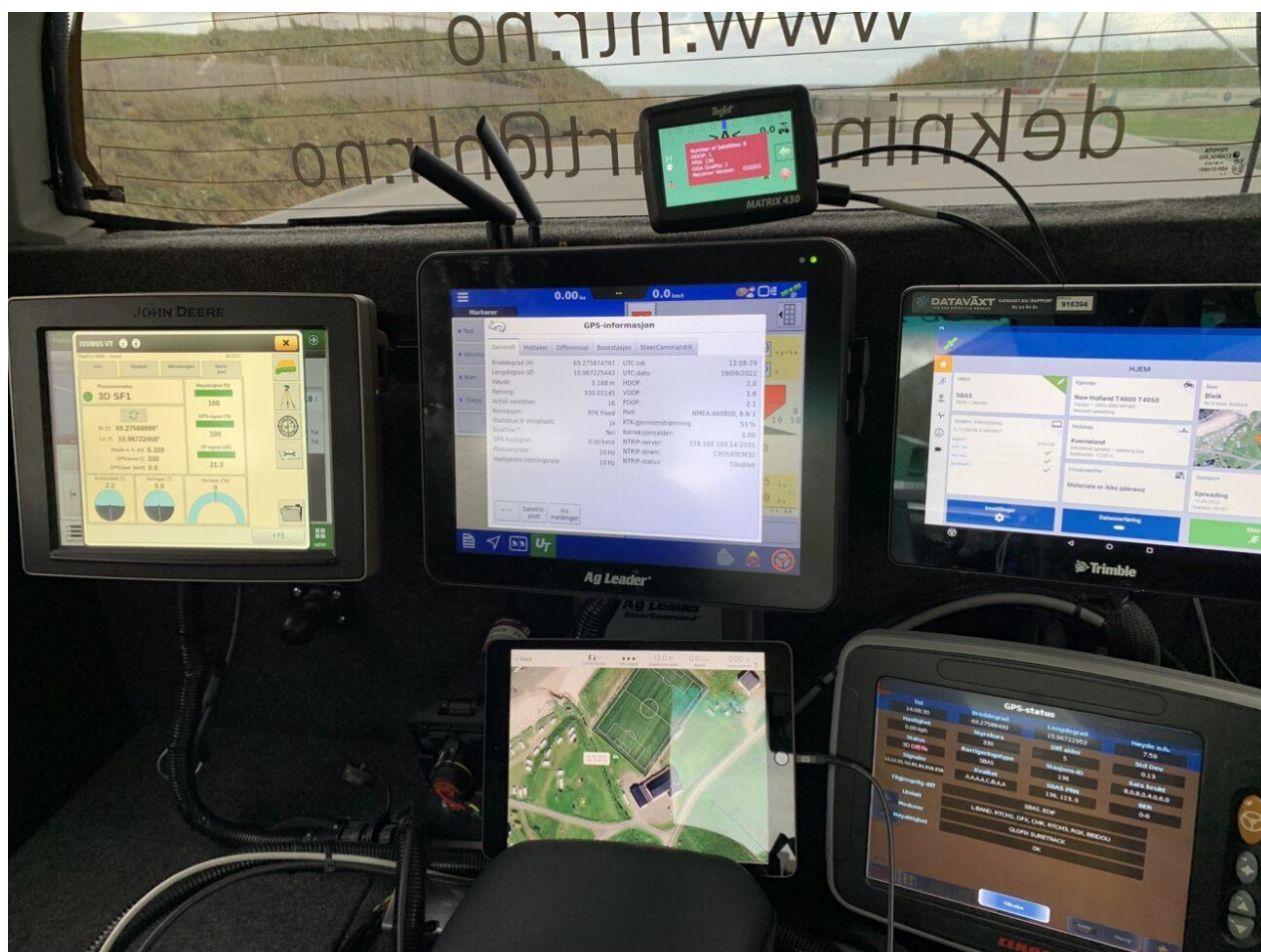
Terminalene montert på bakveggen i bilen, her under jammetesten på Andøya.
